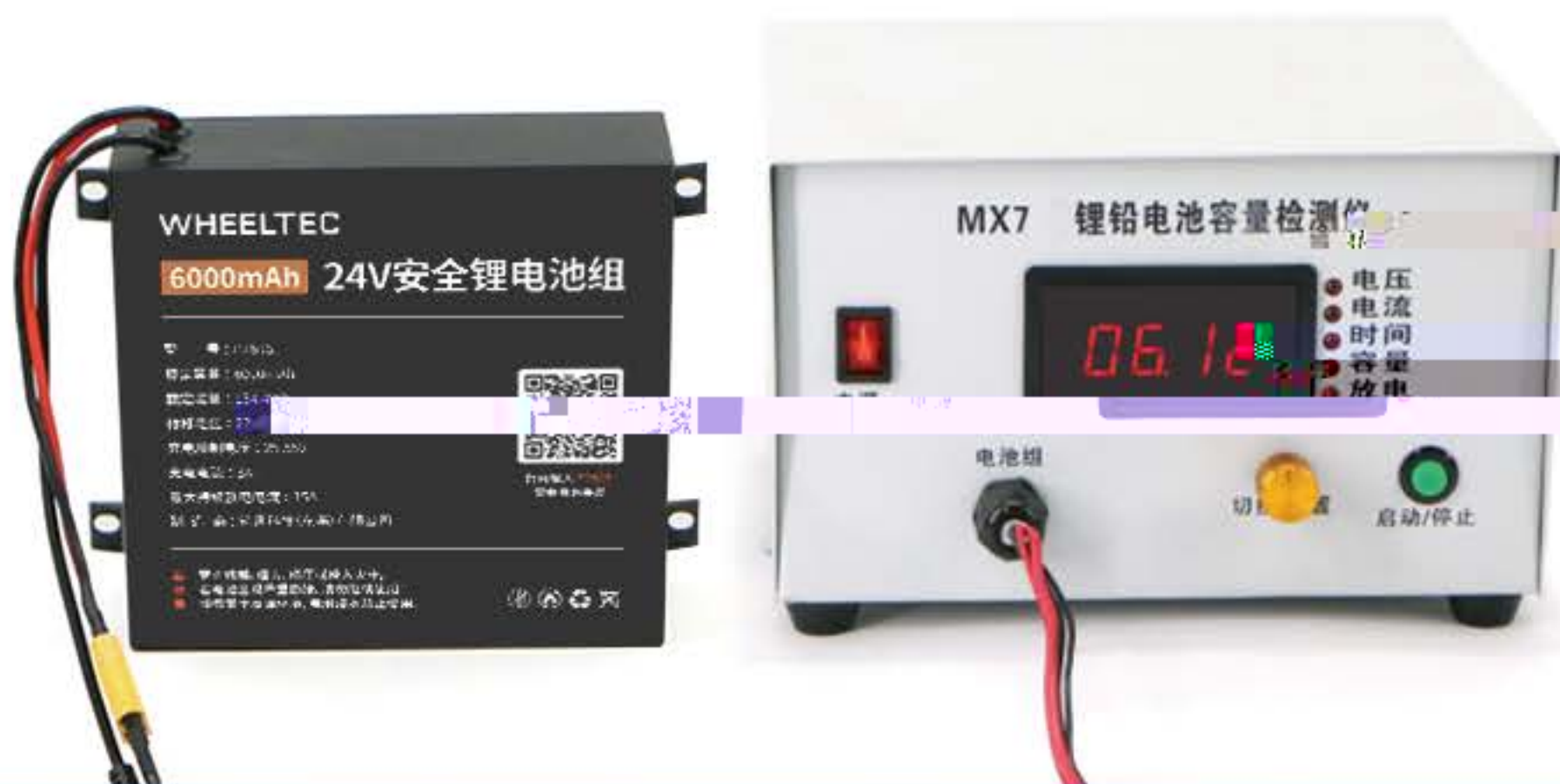
24V 6000mAh磷酸铁锂电池实测 6120 mAh
